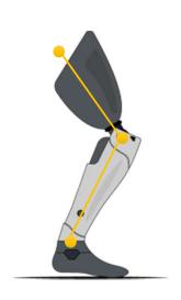
Un système mécatronique unique avec coordination simultanée du mouvement de la cheville et de celui du genou en prolongement de la hanche
